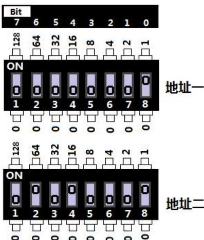
简单计算方法：如左图所示，拨码开关 8 位每位所代表的十进制数值标注在对应的开关位上，向上拨向 ON 时，表示该位的实际数值，向下拨是 0，实际地址等于各位数值之和。
